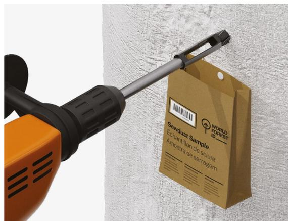
3. Percer à 9 cm, retirer pendant que la perceuse tourne à faible vitesse.
